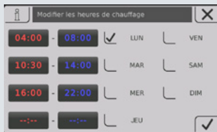
Vue des périodes de chauffage (réglable individuellement)
